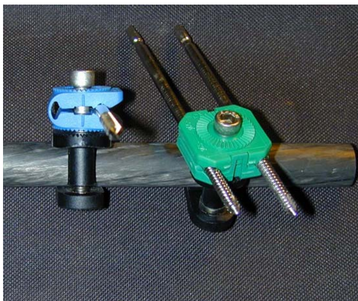
Fig 5 : assemblage de l'ensemble fiches plaquettes colliers barr
