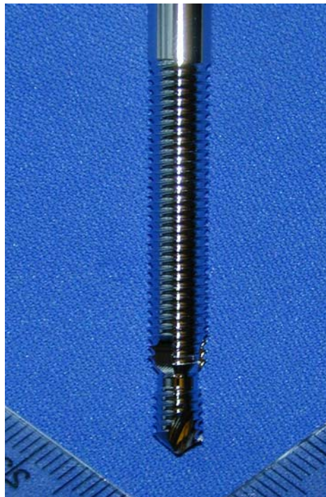
Fig 2 : fiche de 6mm auto-tarodeuse auto-perforante.
