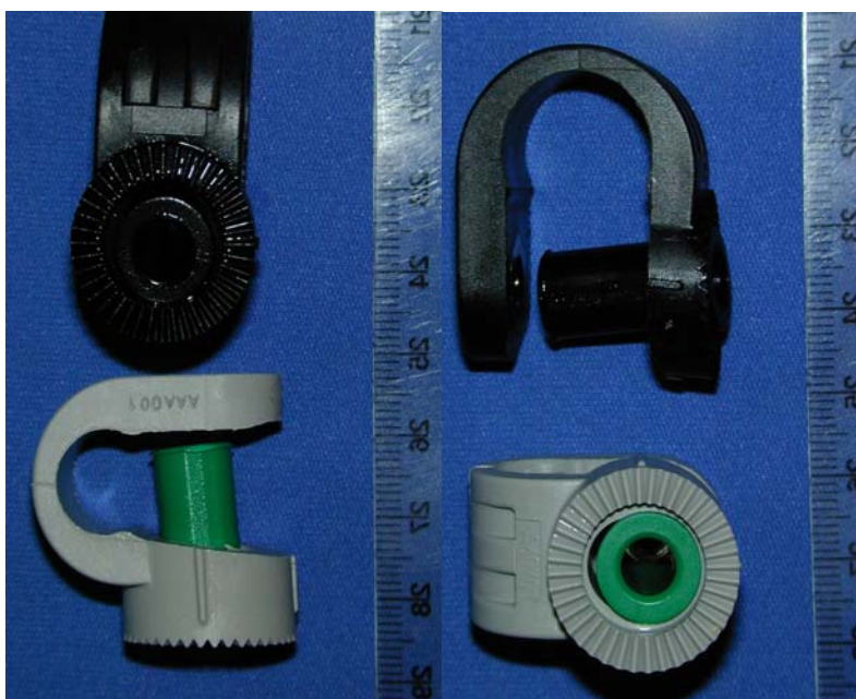
Fig 4 : Colliers crantés de 12mm (gris) et de 18mm (noir).
