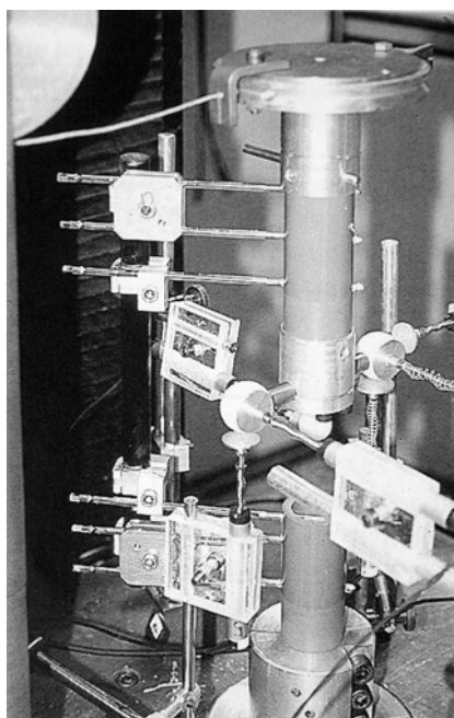
Fig 9 : banc d'essai pour l'évaluation biomécanique du fixateur.
